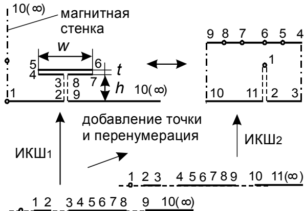
Рис. 2. Конформные отображения половины СМПЛ при чётном возбуждении.
