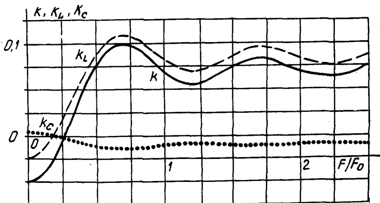
Рис. 2. Частотная зависимость коэффициентов связи
